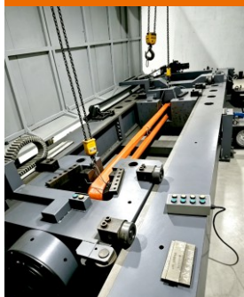
吊装带拉力机静载荷试验
