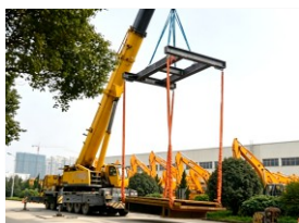
起重吊梁静载荷试验
