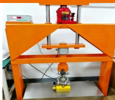
WLL10吨永磁起重器试验台
