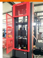
WLL20吨葫芦试验台
