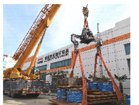
电动卧卷夹具机械机构静载荷试验
