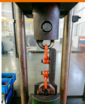
起重吊点静载荷拉力机试验
