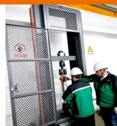
葫芦试验台静载荷试验
