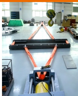
起重吊梁静载荷拉力机试验
