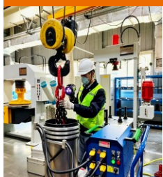
链条、吊装连接件裂纹MT检测
